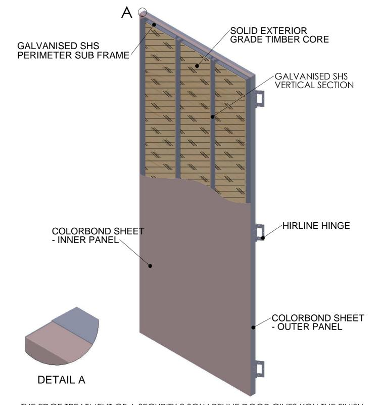
THE EDGE TREATMENT OF A SECURITY 2 SQUARELINE DOOR GIVES YOU THE FINISH OF A TIMBER DOOR AND HIGH SECURITY OF A HEAVY DUTY STEEL CLAD DOOR.
